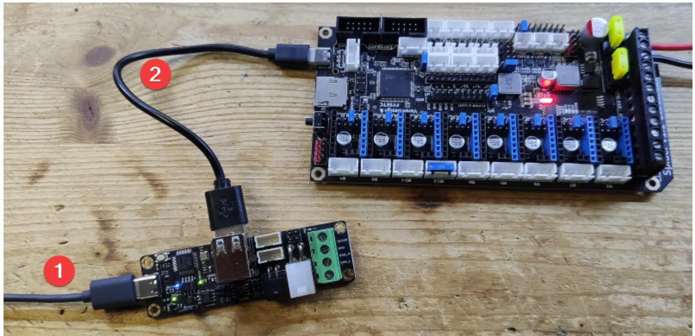
Das U2C Board ist per USB mit dem Raspberry Pi verbunden (1). Über das andere USB-Kabel (2) werden nur die CAN Daten des µControllers übertragen.
