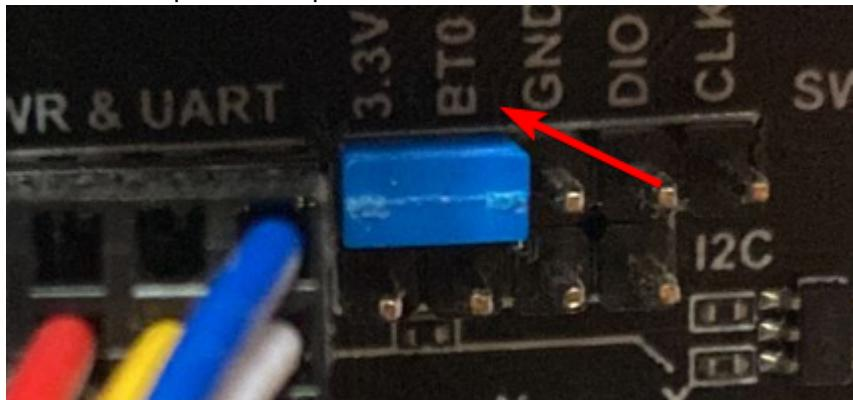
Dieser Jumper legt 3,3V auf den BT0 Pin. Das Board geht damit nach einem Reset in einen speziellen DFU Modus und mittels dfu-util kann dann Katapult geflasht werden.
