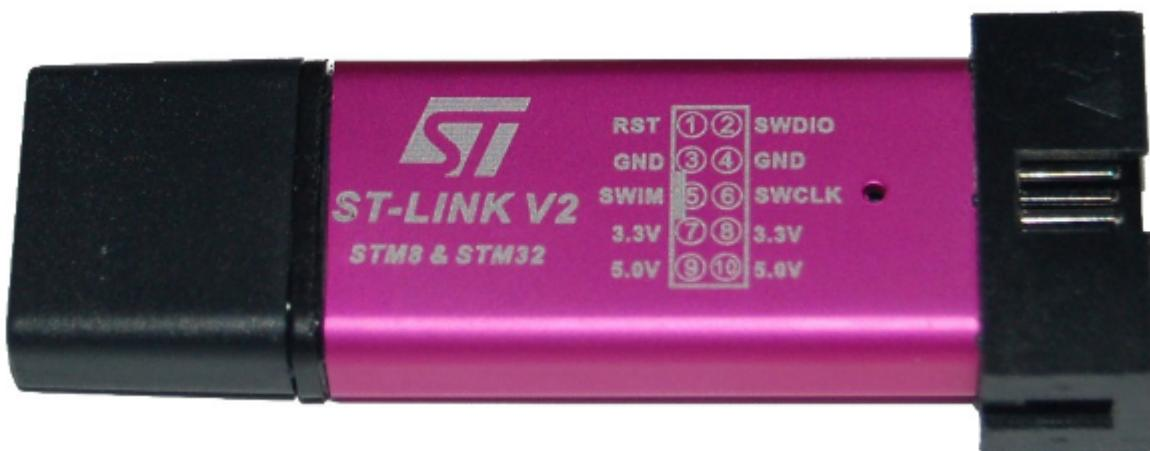
Wenn gar nichts mehr funktioniert, bekommt man mit so einem Adapter fast jeden STM32 wieder flott
