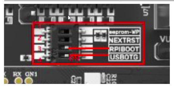
Für den normalen Betrieb müssen diese Schalte ausgeschaltet sein!
